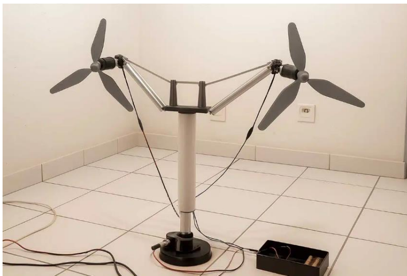
Un prototype miniature d'une éolienne à double rotor. Crédit photo : Sereo Engineering (capture d'écran vidéo amélioration par IA)
